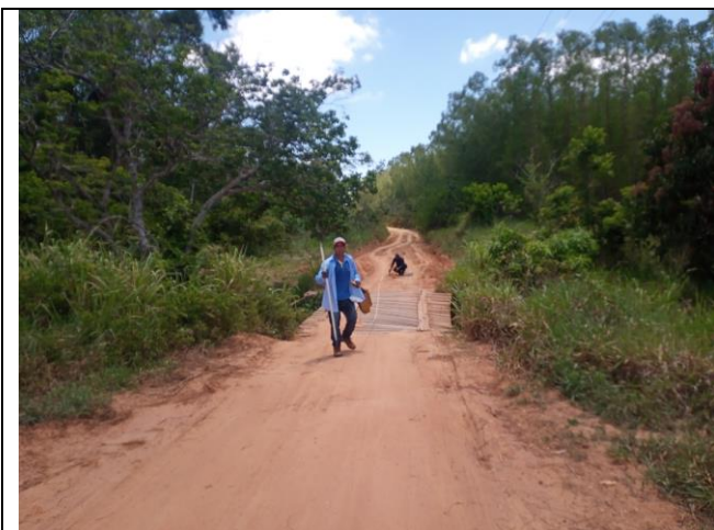
Levantamento topográfico sendo realizado, transporte de coordenadas a partir do RN do IBGE
