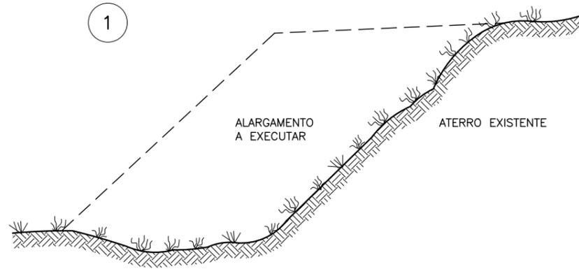
– LIMPEZA DA SAIA DO ATERRO E DO TERRENO ONDE SERÁ EXECUTADO O ALARGAMENTO; CORTE DA SAIA E REGULARIZAÇÃO DO TERRENO NATURAL; COMPACTAÇÃO DA 1ª CAMADA.
