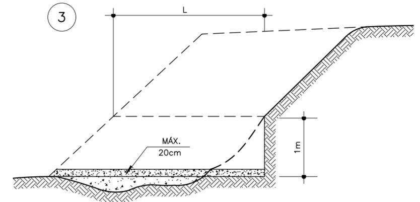
– EXECUÇÃO DE NOVO CORTE NO ATERRO EXISTENTE; PROCESSAMENTO IDÊNTICO ATÉ QUE A LARGURA "L" ATINJA O MÍNIMO PARA O TRABALHO DO EQUIPAMENTO ATÉ ATINGIR AS COTAS DA PLATAFORMA (NOTA DE SERVIÇO).
