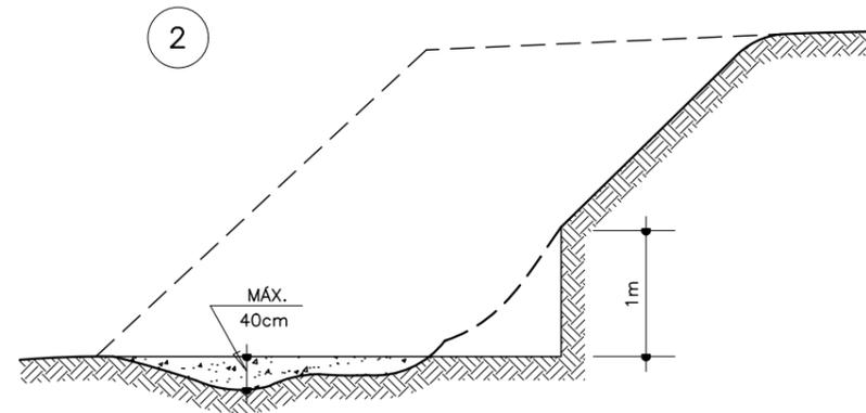
– EXECUÇÃO DA 2ª CAMADA COM MATERIAL DE EMPRÉSTIMO OU CORTE; PROCESSAMENTO IDÊNTICO ATÉ QUE A LARGURA "L" SEJA A MÍNIMA NECESSÁRIA PARA OPERAÇÃO DO EQUIPAMENTO.
