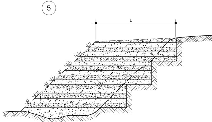
– NA EXECUÇÃO DA PRIMEIRA CAMADA DE REGULARIZAÇÃO SOBRE O TERRENO NATURAL, SERÁ PERMITIDA UMA ALTURA MÁXIMA DE 40cm APÓS COMPACTAÇÃO.
