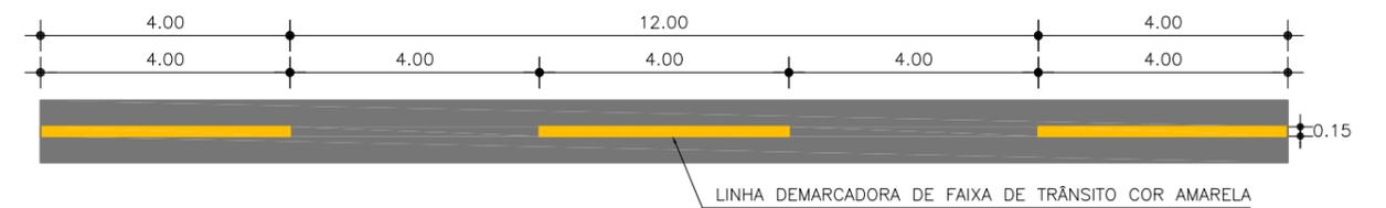
DETALHE DA LINHA DE PROIBIÇÃO DE ULTRAPASSAGEM - (CADÊNCIA 4,00x4,00 / CONTÍNUA)
